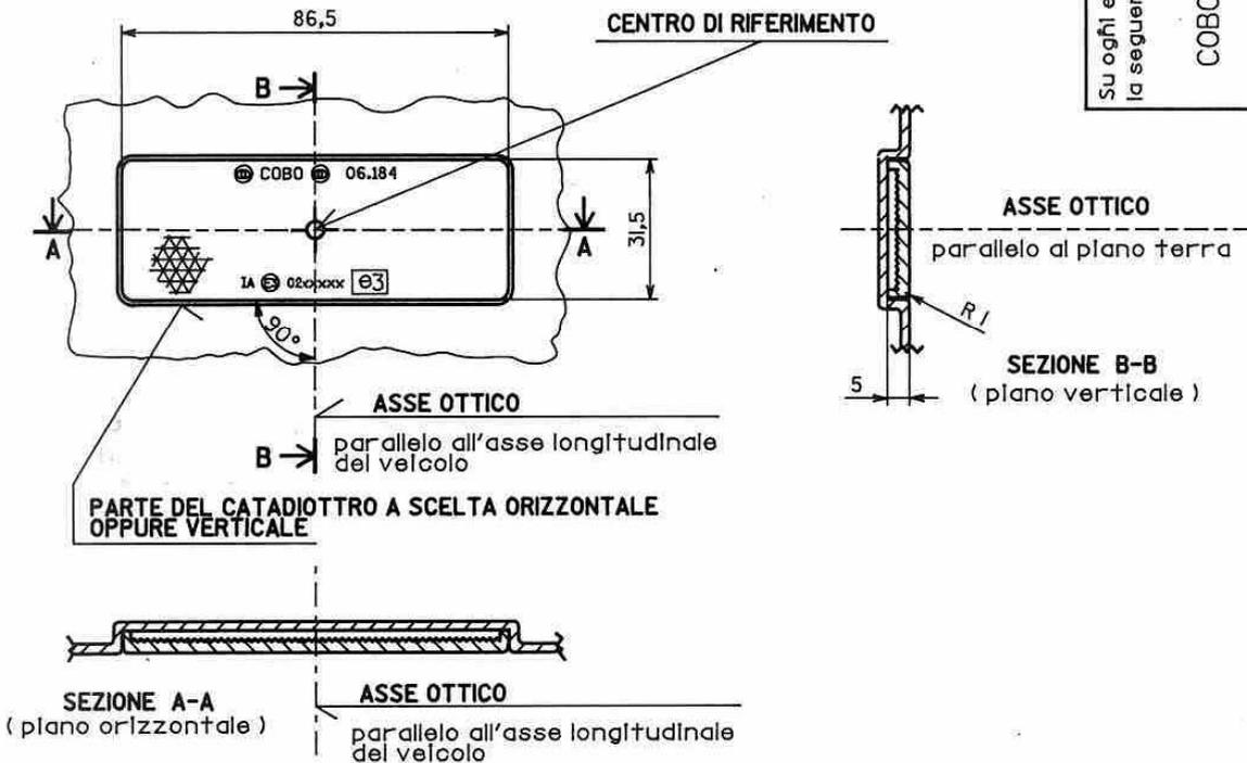
**LIMITI DELLE SUPERFICI ILLUMINANTI ( In mm ) INTENSITA' IN ASSE**
