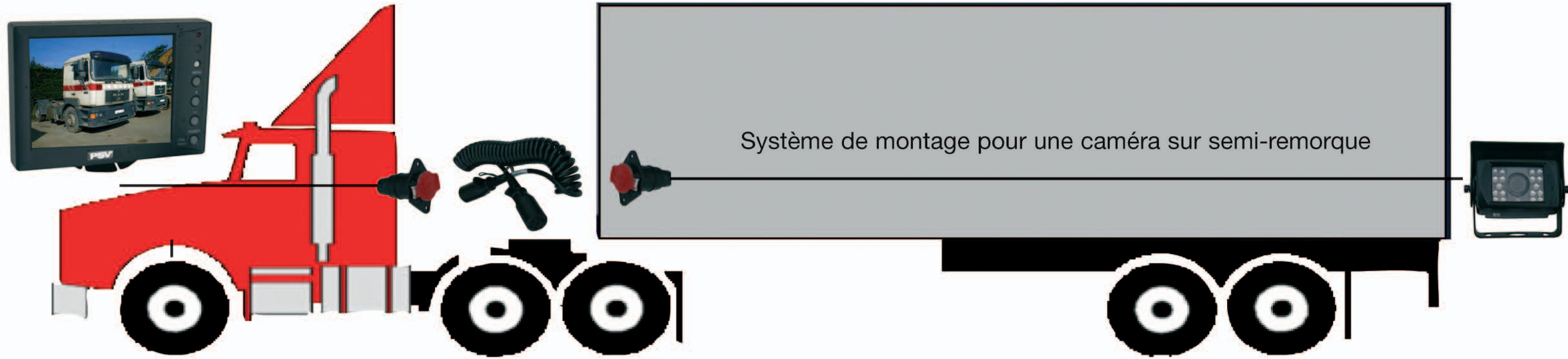
Système de montage pour une caméra sur semi-remorque
