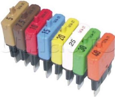
Disjoncteur thermique unipolaire de faible épaisseur pour véhicules. Avec languettes de dimension et d'écartement compatibles avec les fusibles universels à fiches ISO8820. Enfichables dans les socles porte-fusibles. La couleur du disjoncteur correspond à celle des fusibles classiques de même intensité.
