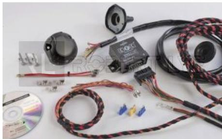
Faisceaux d'attelage 7 pôles pour T5 GP fourgon / Break châssis-cabine depuis 10/2009
