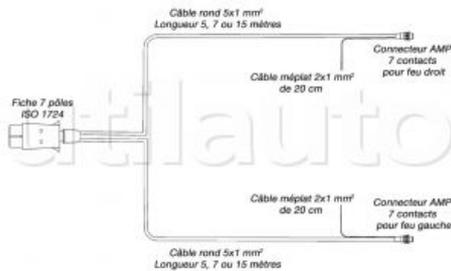
Faisceau simple avec fiche 7 pôles ISO1724 équipé de 2 connecteurs AMP pour brancher les feux arrières 3 ou 4 fonctions et de 2 retours de 20 cm de câble méplat 2x1 mm<sup>2</sup> pour connecter des feux auxiliaires équipés de clips rapides
