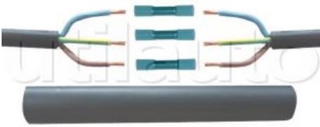
Kit pour maintenance ou réparation sur connexions de câbles et de faisceaux, composé de connecteurs «bout à bout» à sertir + thermorétractables et de manchons de gaine thermo rétreint 3 : 1 + colle intérieure à paroi épaisse.
