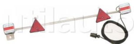
Rampe télescopique de 1,40 mètre à 2,10 mètres
