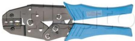
Pince à sertir professionnelle avec verrouillage pour cosses pré-isolées de section DIN 1,5, 2,5 et 6 mm<sup>2</sup> et AWG 22~16, 16~14 et 12~10
